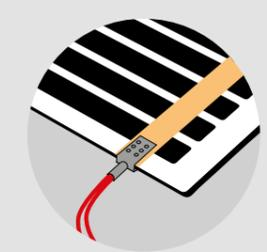
Подключение проводов к нагревательной пленке
